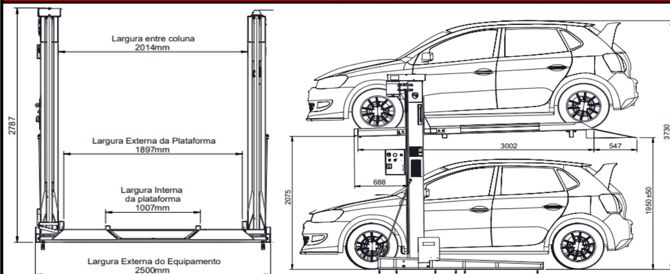
OBS: O veículo na imagem tem 1569mm de altura e 4230mm de comprimento.
